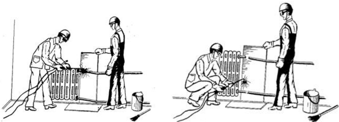
Рис. 2.8. Перерезание верхней подводки; перерезание обратной подводки
