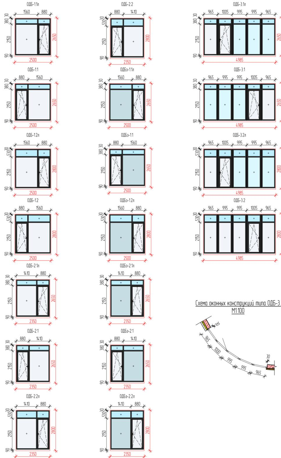
Схема оконных конструкций типа ОДБ-3
